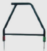
Ramka A-Frame – lokalizator uszkodzeń powłok rur i kabli
